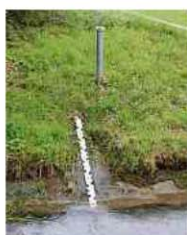
Der Pegel in St. Margarethen misst Abfluss und Wassertemperatur des Krebsbachs.
